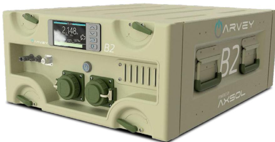
Der Body 2 verfügt über zwei Steckdosen zum Anschluss von 230V AC Verbrauchern und bezieht die elektrische Energie aus einer sicheren Lithium-Eisenphosphat (LiFe-PO4) Batterie. Um die Batterie wieder aufzuladen kann der Body 2 an einen Generator oder an das Stromnetz angeschlossen werden. Es ist auch möglich, die Batterie mit Solarenergie zu laden.
